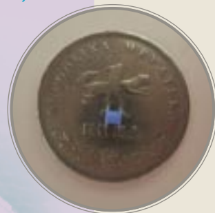
Ventilacijska cjevčica. (Odnos veličine prema kovanici od 1 kune.)
